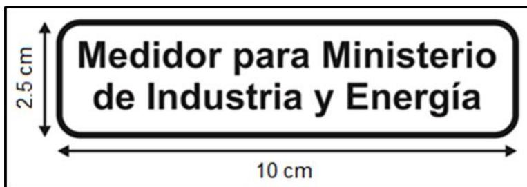
En el caso que la medida sea indirecta, es decir se utilicen Transformadores de Corriente (TC) de BT, el Puesto de Conexión de la IMG deberá disponer de una etiqueta con las relaciones de los TC.
